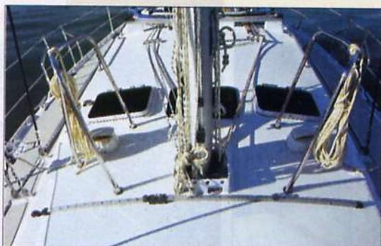
**Sopra, la base dell'albero con i due pulpiti da lavoro e la rotaia della trinchetta autovirante.**
